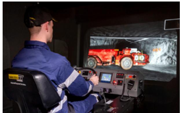
Simulateur pour le camion souterrain Sandvik TH545i
