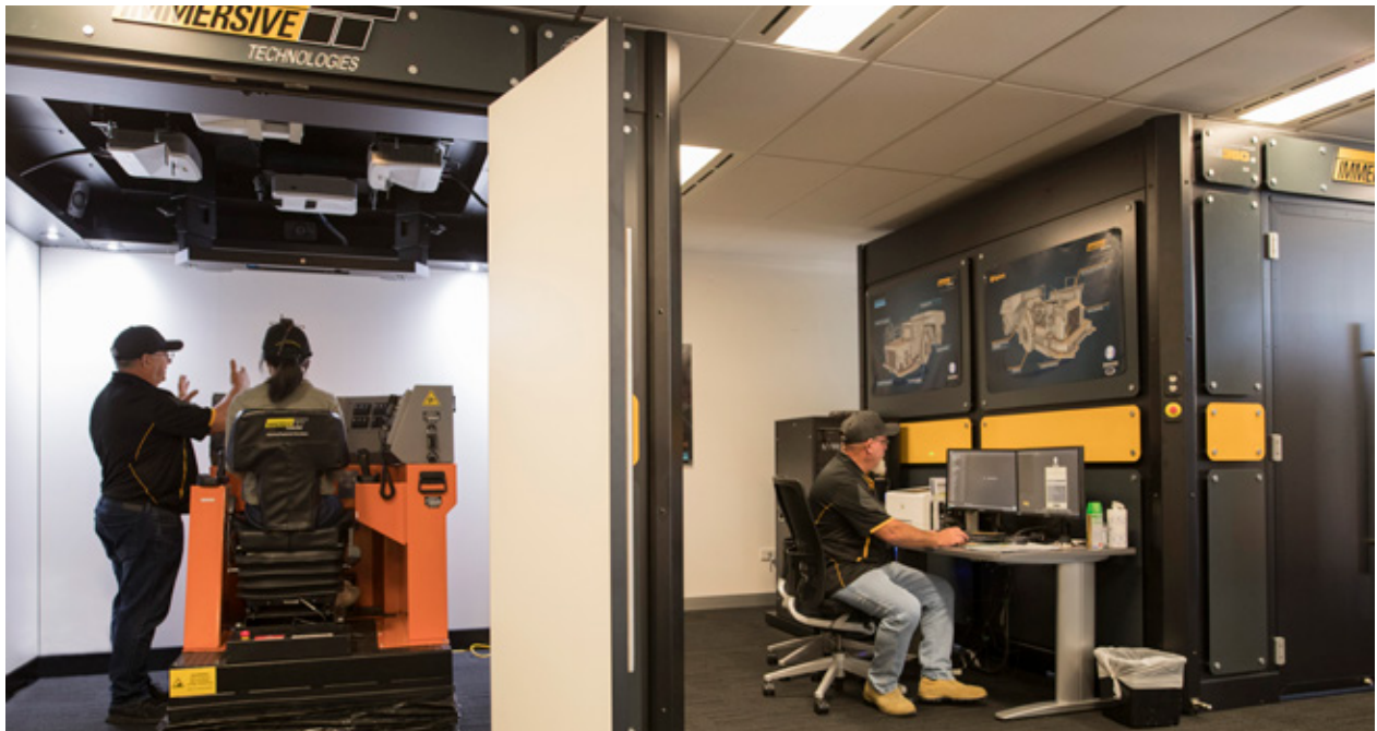
Le centre de formation et d'introduction de Byrnecut avec ses simulateurs miniers IM360-b
