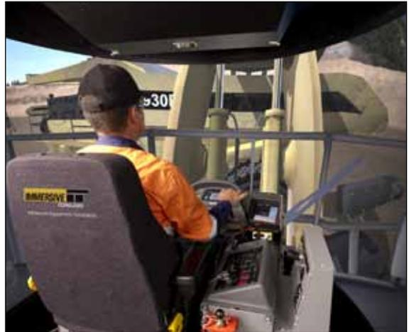
*Operador utilizando un Cargador de Ruedas Komatsu WA1200-3 en el Simulador PRO3 para minería de superficie.*
